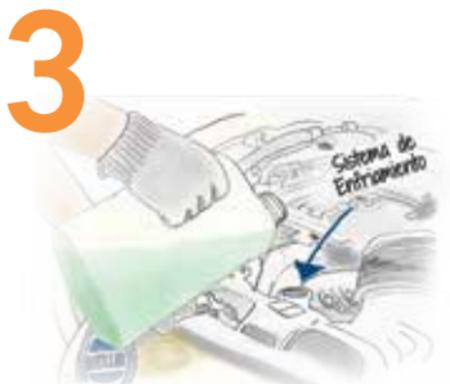
Ahora aplique únicamente agua y vuelva a drenar el sistema para evitar que queden sedimentos en los componentes. Cierre la válvula de drenaje del radiador. Llene el sistema aplicando **la mezcla ideal de anticongelante / agua recomendada por el fabricante**. Encienda el motor y permita que llegue a su temperatura normal de trabajo.
