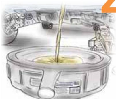
Debe drenar el radiador para eliminar óxido y sedimentos, para ello, abra la válvula de drenaje del radiador, coloque un recipiente grande para recibir el anticongelante usado (Aproximadamente dos galones). Al finalizar cierre la válvula de drenaje.
